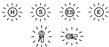
Estos parpadeos indican que un borne o una pinza amperimétrica debería estar conectado/a y no lo está, o que está conectado/a cuando no tendría que estarlo. Debe restablecer las conexiones correctas, si no la medida no se puede tomar.
