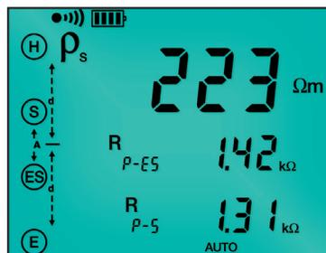
La prueba de Schlumberger muestra la conexión de los cables de prueba, los resultados de la prueba de resistividad del suelo ( $\rho$ ), la resistencia del electrodo de prueba y más.
