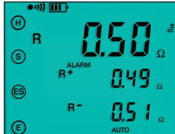
La prueba de 4 puntos muestra las conexiones de los cables de medición, los resultados de pruebas de continuidad, y la tensión y corriente de
