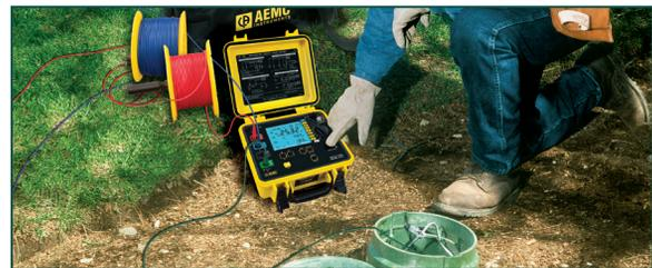
El modelo 6472 provee una medición automática del valor de resistencia de tierra usando el método de caída de potencial y almacenamiento de mediciones.
