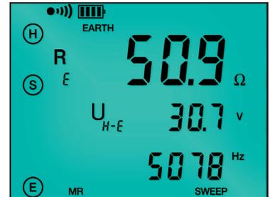
Método de caída de potencial de 3 puntos muestra la conexión del cable de prueba, la resistencia del electrodo de tierra, la tensión de prueba y la frecuencia.
